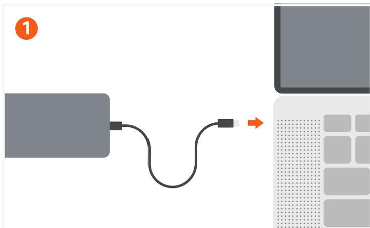
1 Schließen Sie den Adapter an einen kompatiblen USB-C-Anschluss an Ihrem Host-Gerät an.
