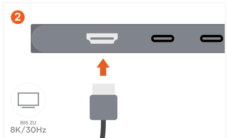
2 Nutzen Sie den HDMI-Anschluss für die Videoausgabe an einen externen Monitor / Bildschirm - bis zu 8K bei 30Hz oder 4K bei 60Hz/120Hz/144Hz. Computer, Kabel und Monitor müssen 8K unterstützen. 8K-Videoausgabe wird auf Mac-Geräten nicht unterstützt.
