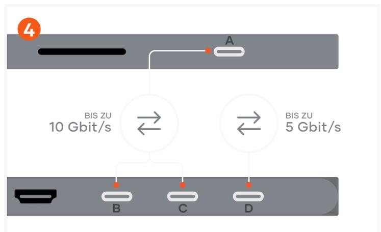
4 USB-C-Datenanschlüsse ermöglichen Datenübertragung mit bis zu 10Gbit/s (A, B, C) und 5Gbit/s (D).
