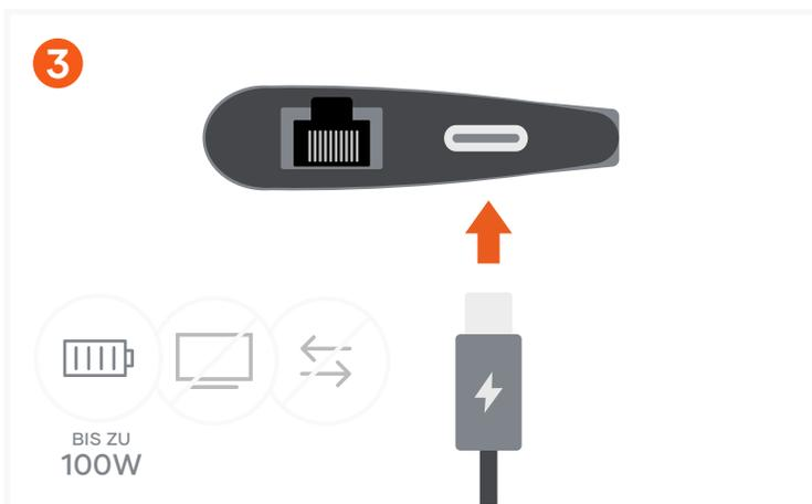
3 Laden Sie Ihr Gerät über den USB-C-PD-Anschluss mit bis zu 100 W.
