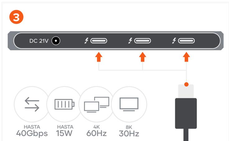
Conecta hasta tres dispositivos USB-C a los puertos Thunderbolt 4 del Hub. Es compatible con hasta 40Gbps, 15W de carga, salida de vídeo dual 4K hasta 60Hz en total o salida de vídeo 4K individual a 30Hz. macOS no es compatible con una salida de vídeo 8K.
