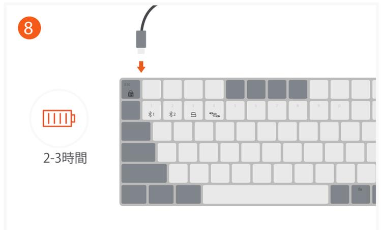
8 充電するには、付属ケーブルでキーボードを給電できるUSB-Cポートに接続します。赤いランプが消えるまで2-3時間充電します。
