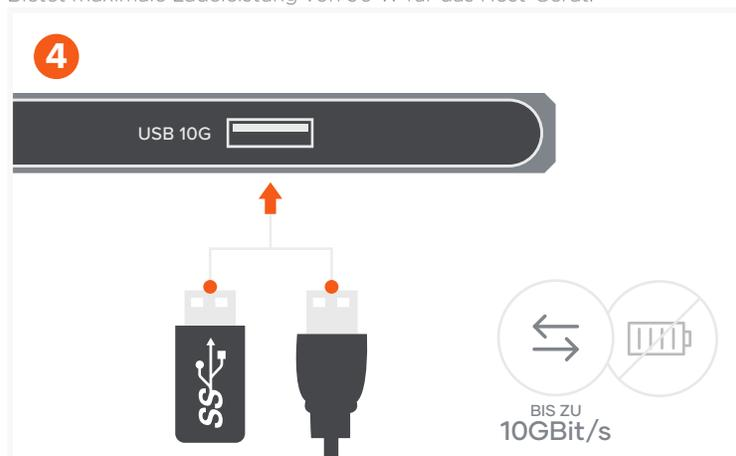
Der USB 3.2 Gen 2-Anschluss ermöglicht Datenübertragungen mit einer Geschwindigkeit von bis zu 10Gbit/s.
