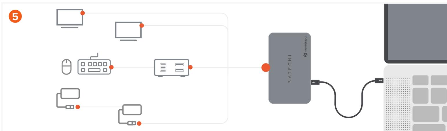
Ermöglicht die Verkettung von bis zu 6 Geräten
