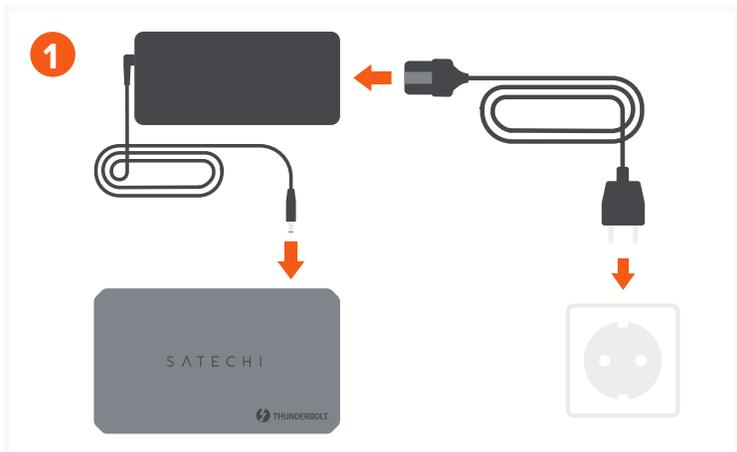
Schließen Sie den Netzadapter am Gleichstromanschluss des Hubs direkt an eine Steckdose an.
