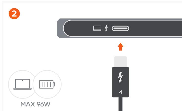
Verbinden Sie den Hub über das mitgelieferte Thunderbolt 4-Kabel mit Ihrem Host-Gerät über den Thunderbolt 4-Host-Anschluss an der Vorderseite des Hubs.
