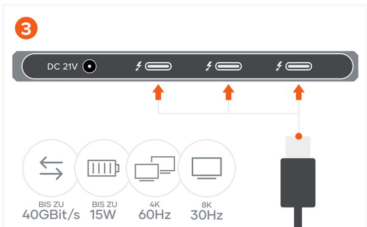
Schließen Sie bis zu drei USB-C-Geräte an die Thunderbolt 4-Ports des Hubs an. Unterstützt bis zu 40Gbit/s, 15W Ladeleistung, duale 4K-Videoausgabe mit bis zu 60Hz insgesamt oder einzelne 8K-Videoausgabe mit 30Hz. macOS unterstützt keine 8K-Videoausgabe.
