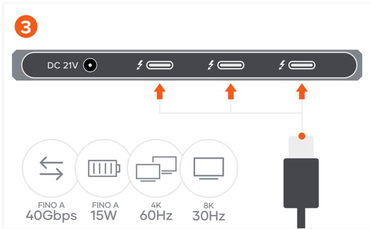
Collegare fino a tre dispositivi USB-C alle porte Thunderbolt 4 dell'hub. Supporta fino a 40Gbps, ricarica 15W, doppia uscita video 4K fino a 60Hz totali o uscita video singola 8K a 30Hz. macOS non supporta l'uscita video 8K.
