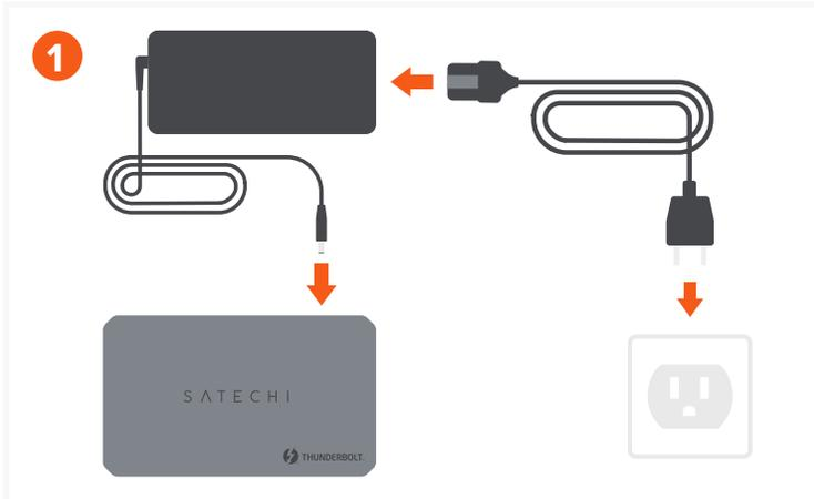
Conecta el adaptador de corriente al puerto DC del Hub directamente a un enchufe de pared.
