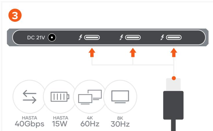
Conecta hasta tres dispositivos USB-C a los puertos Thunderbolt 4 del Hub. Es compatible con hasta 40Gbps, 15W de carga, salida de vídeo dual 4K hasta 60Hz en total o salida de vídeo 4K individual a 30Hz.
