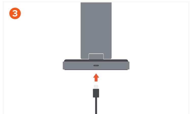
Branchez le câble USB-C sur le port USB-C arrière du Support de Charge.
