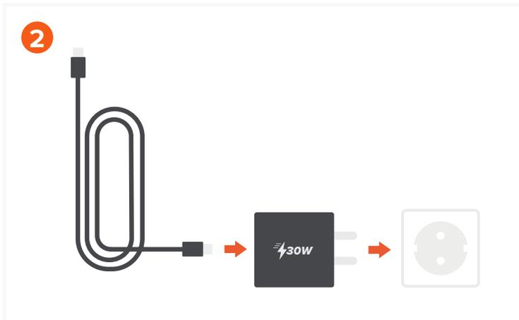
2 Verbinden Sie das USB-C-Ladekabel (im Lieferumfang enthalten) mit einem Netzadapter (nicht im Lieferumfang enthalten). Für optimale Nutzung ist ein 30W-Netzadapter erforderlich.
