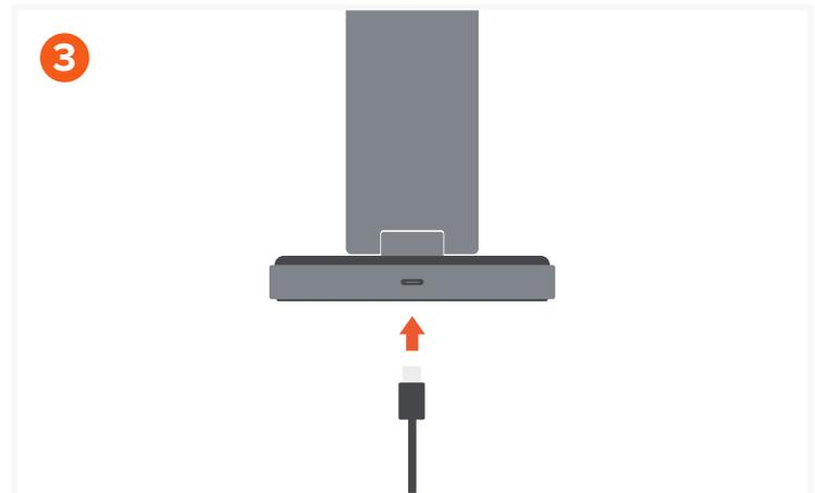
3 Verbinden Sie das USB-C-Kabel mit dem hinteren USB-C-Anschluss der Ladestation. Die frontseitige LED-Anzeige leuchtet, sobald das Gerät mit dem Stromnetz verbunden ist.
