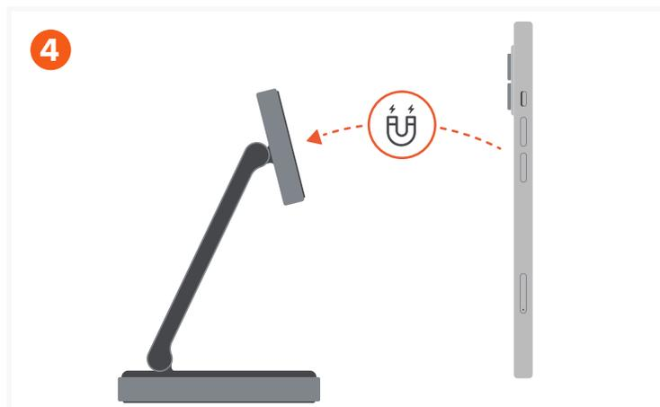
4 Legen Sie zum Starten des Ladevorgangs ein kompatibles iPhone auf das Qi2-Ladegerät. Unterstützt Ladegeschwindigkeiten von bis zu 15W.
