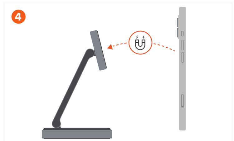
Placez l'iPhone compatible sur le chargeur Qi2 pour commencer la charge. Prend en charge des vitesses de charge jusqu'à 15W.
