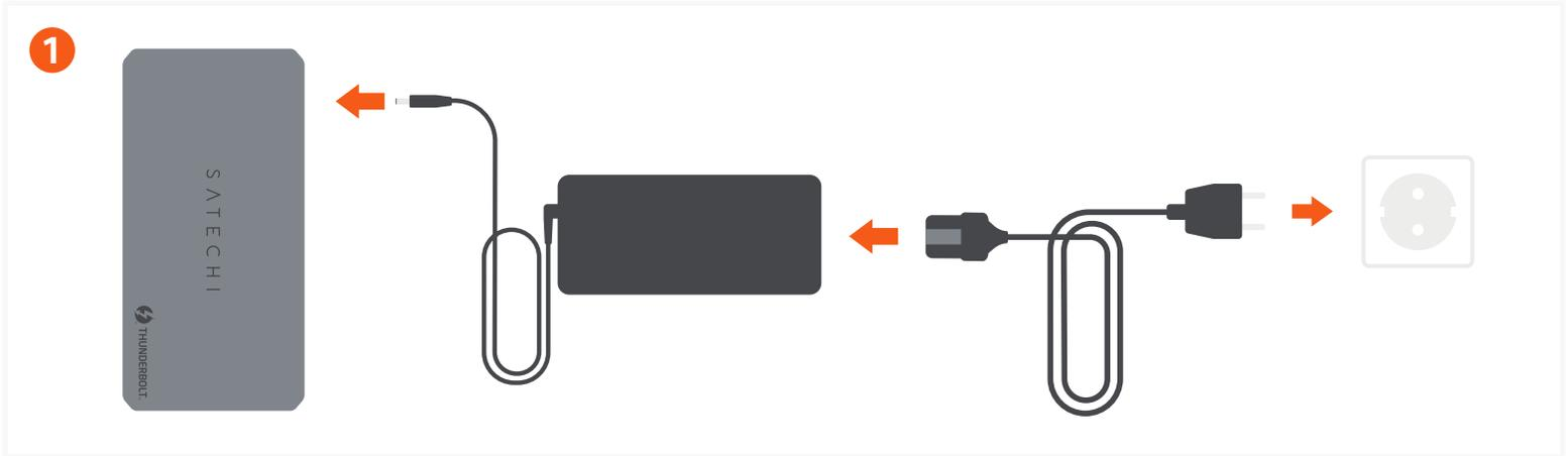
Conecte la fuente de alimentación de 180W incluida a la estación de acoplamiento. Una vez conectado, la estación de acoplamiento se encenderá automáticamente.
