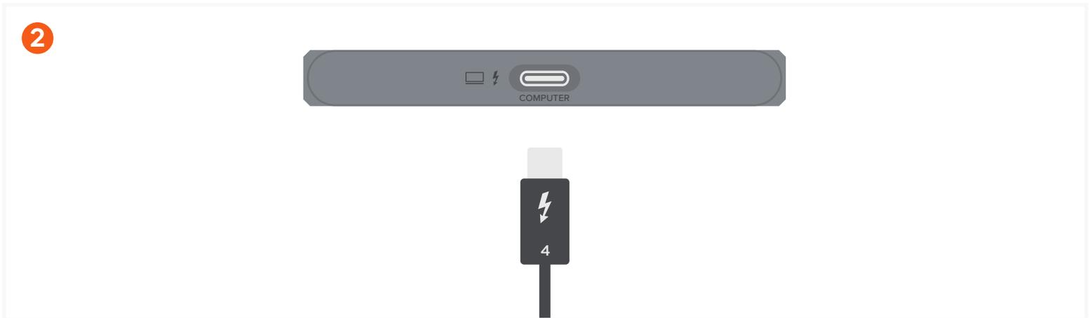
Conecte la estación de acoplamiento a su dispositivo host utilizando el cable Thunderbolt 4 incluido. El puerto del host se encuentra en el lado derecho de la estación de acoplamiento.
