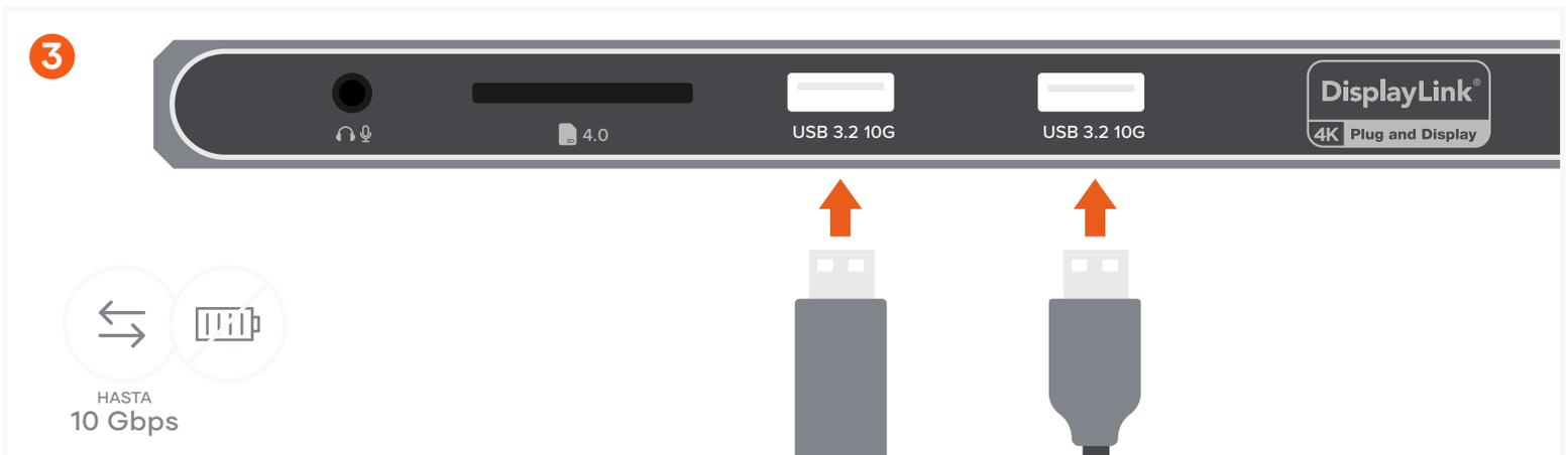
Use los dos puertos de datos USB-A 3.2 Gen 2 para transferencias de datos rápidas y copias de seguridad de archivos. Hasta 10 Gbps cada uno. No admite la carga ni los lectores de CD, incluido Apple SuperDrive.
