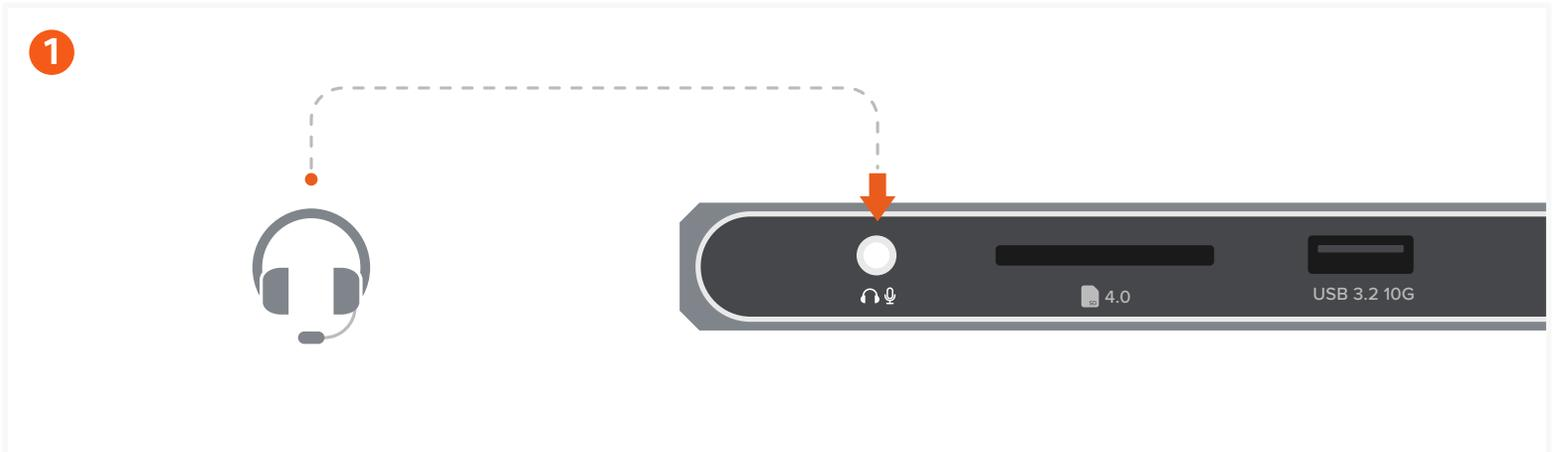
Conecte el dispositivo de audio al conector de audio de 3,5 mm. Necesitará cambiar la configuración de salida/entrada de sonido al conectar auriculares/micrófono. (Configuración del sistema > Sonido > Salida y entrada > DisplayLink Audio)
