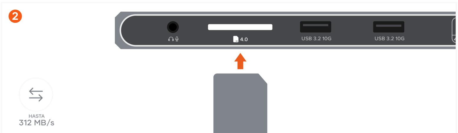
Inserte la tarjeta SD en el lector de tarjetas SD 4.0. Soporta velocidades UHS-II (hasta 312 MB/s).
