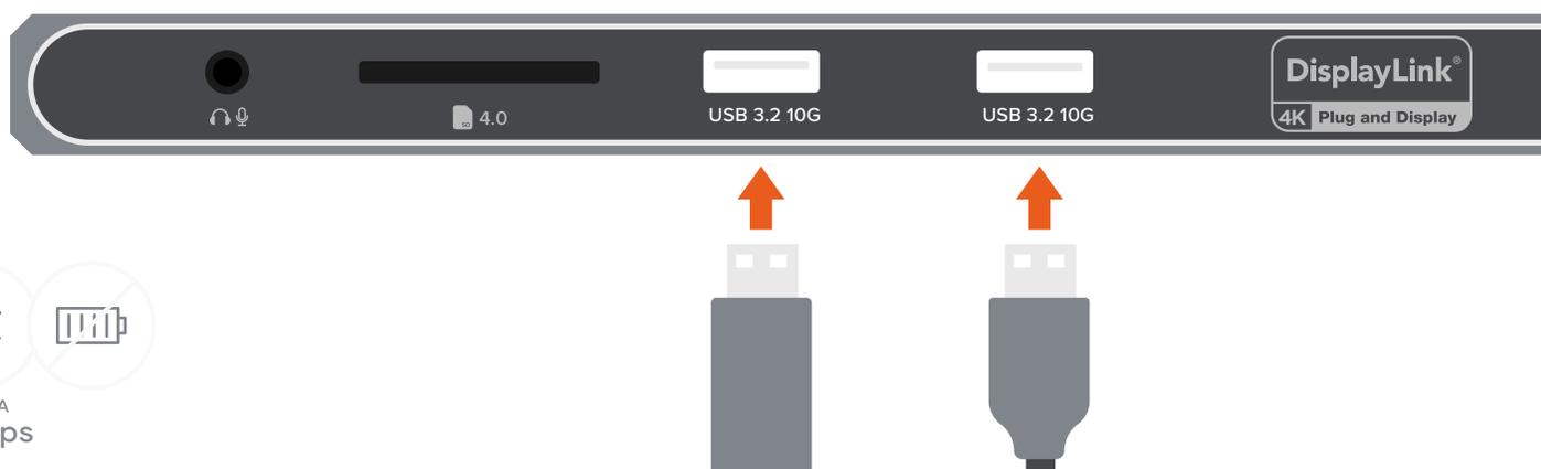
Usare le due porte dati USB-A 3.2 Gen 2 per il trasferimento rapido dei dati e il backup dei file.
