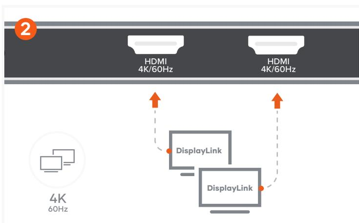
Utilizzare le porte HDMI per collegare fino a due monitor HDMI. Supporta 4K/60Hz ognuna. Occorre installare DisplayLink Manager per utilizzare le porte HDMI.
