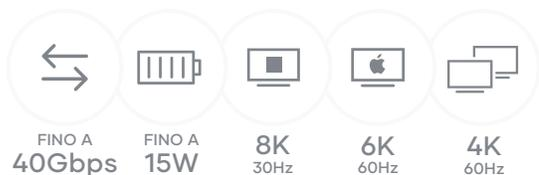
Utilizzare le tre porte Thunderbolt 4 per il trasferimento rapido dei dati e l'uscita su display esterno. Fino a 40Gbps e fino a 15W ognuna. Supporta fino a due display esterni. Supporta la risoluzione 8K/30Hz con un solo display collegato (solo Windows), la risoluzione 6K/60Hz con un solo display collegato quando si usa il Mac, la risoluzione 4K/60Hz con due display collegati.
