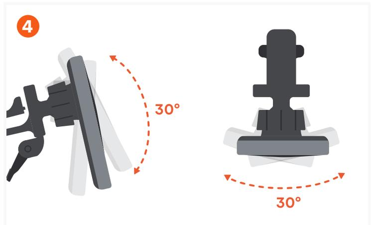
Una vez que el cargador esté montado, puede ajustar su ángulo de visión en 30 grados.
