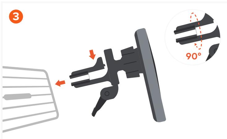
Empuje la palanca para abrir la abrazadera y fíjela a las rejillas de ventilación del automóvil.
