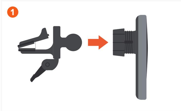
Encaje la pieza de montaje en la parte trasera del cargador.
