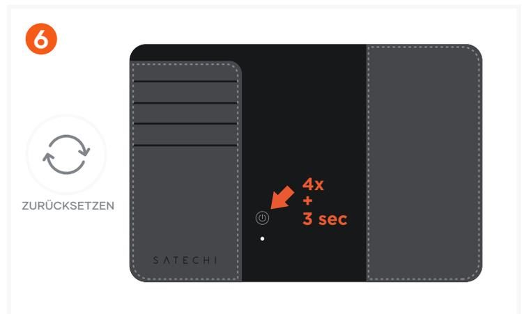
Um die Reisepassschutzhülle auf Werkseinstellungen zurückzusetzen, drücken Sie schnell viermal die Einschalttaste und halten Sie sie dann mindestens 3 Sekunden lang gedrückt. Sie hören einen Bestätigungston, der anzeigt, dass das Zurücksetzen abgeschlossen ist.
