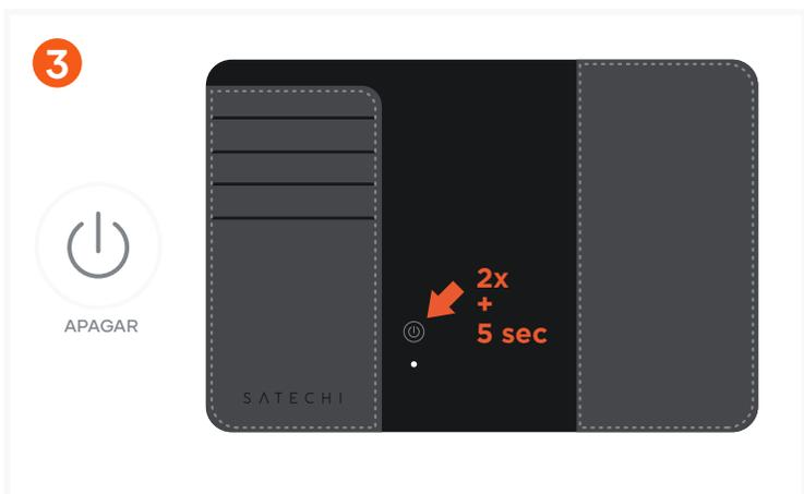
3 Para apagar la funda para pasaporte, presiona rápidamente el botón de encendido 2 veces y luego manténgalo presionado durante al menos 5 segundos hasta que escuche dos pitidos. Cuando el dispositivo está apagado, no puede rastrear tu ubicación.
