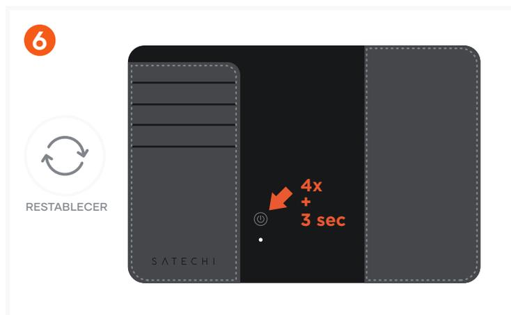
6 Para restablecer de fábrica tu funda para pasaporte, presiona rápidamente el botón de encendido 4 veces y luego manténlo presionado durante al menos 3 segundos. Escucharás un sonido de confirmación que indica que el restablecimiento de fábrica se ha completado.
