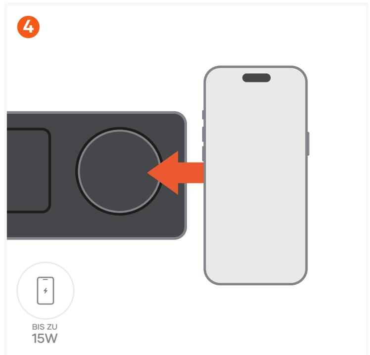
Legen Sie ein kompatibles Gerät auf das Qi2-Ladegerät, um den Ladevorgang zu starten. Unterstützt das Laden mit bis zu 15W. Das Telefon kann flach auf das Ladepad gelegt werden.
