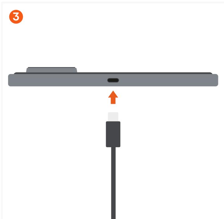
Stecken Sie das USB-C-Kabel in den hinteren USB-C-Anschluss des Ladepads. Die vordere LED-Anzeige leuchtet auf, wenn das Ladegerät mit Strom versorgt wird.
