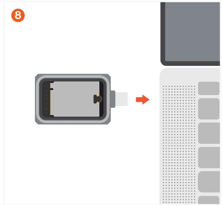
Conecta la caja Mini NVMe al dispositivo principal utilizando el conector USB-C. La caja es compatible con fundas de hasta 2,5 mm de grosor. Para fundas que superen este grosor o dispositivos con espacio limitado, utiliza el cable de extensión incluido.
