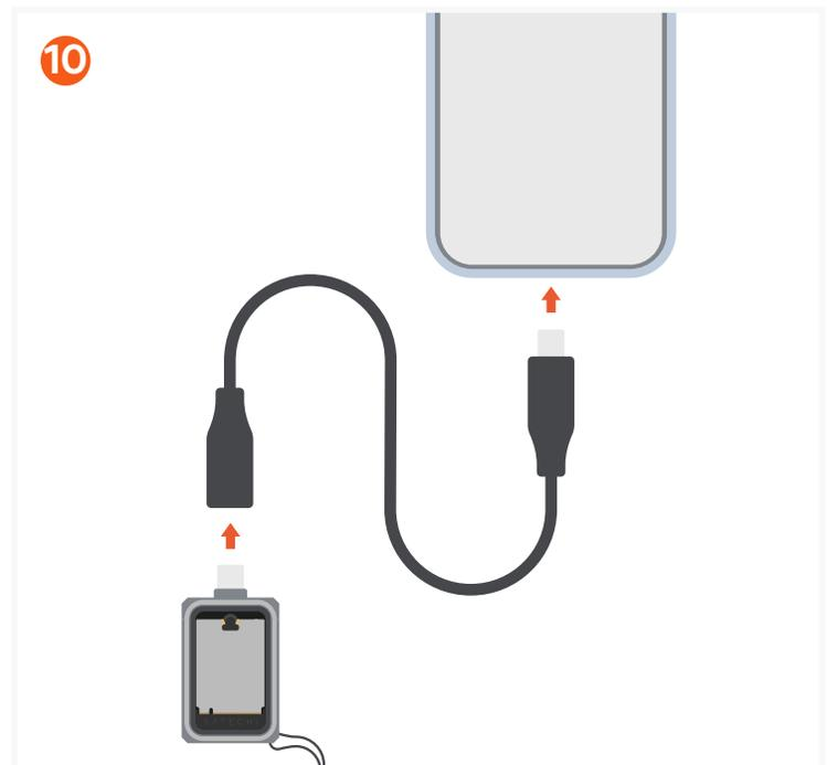
Conecta el extremo hembra del cable de extensión al conector USB-C de la caja, y el extremo USB-C del cable al dispositivo principal (como un ordenador, concentrador, base o adaptador).
