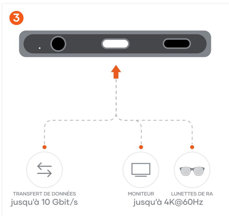
Connectez un câble Thunderbolt 4, USB4 ou USB-C vers HDMI/DP au port USB-C. Prend en charge l'USB 3.0 à 10 Gbit/s, DP1.4 à 2 voies avec 8,1 Gbit/s par voie, DP1.2 à 4 voies pour iPhone 15 et 16, et le mode 4K@60Hz selon le périphérique hôte et l'écran.
