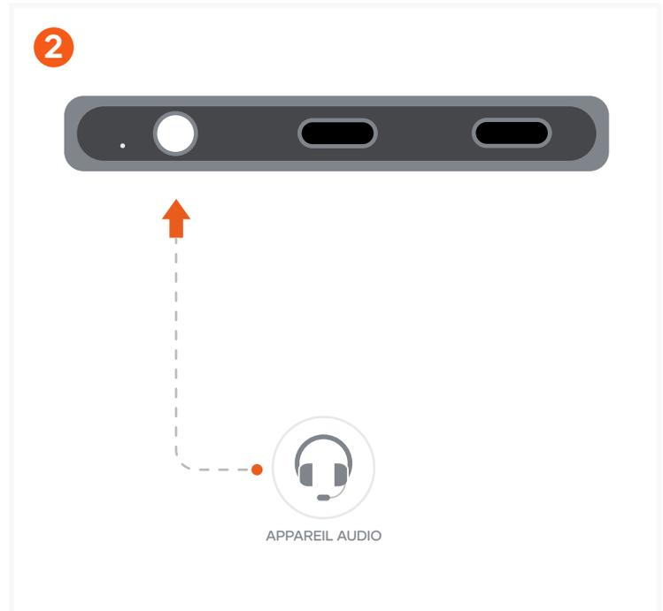
Insérez un appareil audio dans le port auxiliaire 3,5 mm. Prend en charge la prise audio 3,5 mm, l'audio 2.1 canaux et l'entrée microphone. Compatible avec les normes CTIA et OMTP et inclut une fonction de contrôle du volume.
