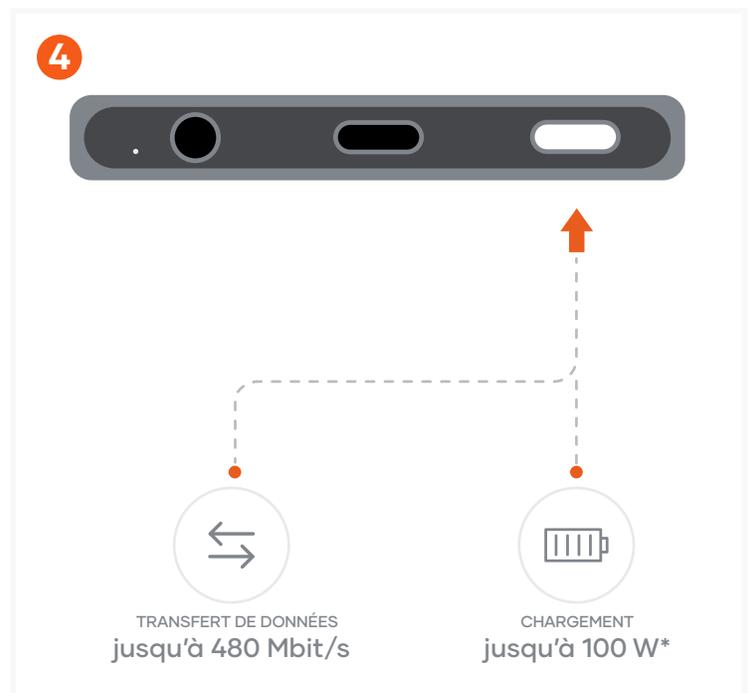
Connectez un câble de charge USB-C à l'un des ports USB-C PD. Prend en charge l'USB 2.0, plug & play; PD3.1 SPR, avec une entrée maximale jusqu'à 100 W selon le périphérique hôte.
