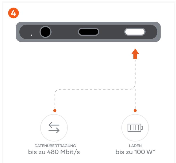
Schließen Sie ein USB-C-Ladekabel an einen der USB-C PD-Anschlüsse an. Unterstützt USB 2.0, Plug & Play; PD3.1 SPR mit einer maximalen Eingangsleistung von bis zu 100 W, abhängig vom Host-Gerät.
