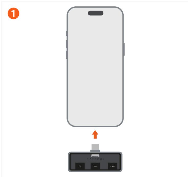
Schließen Sie den Adapter an ein kompatibles Host-Gerät an.
