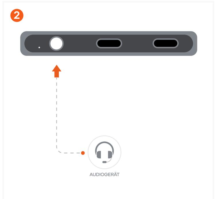
Stecken Sie ein Audiogerät in den 3,5-mm-Aux-Anschluss. Unterstützt 3,5-mm-Audiobuchse, 2.1-Kanal-Audio und Mikrofoneingang. Unterstützt die CTIA- und OMTP-Standards und verfügt über eine Lautstärkeregelung.
