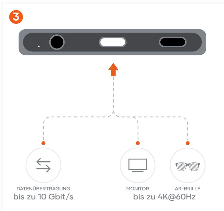
Schließen Sie ein Thunderbolt 4-, USB4- oder USB-C-zu-HDMI/DP-Kabel an den USB-C-Anschluss an. Unterstützt USB 3.0 mit 10 Gbit/s, 2-Lane-DP1.4 mit 8,1 Gbit/s pro Lane, 4-Lane-DP1.2 für iPhone 15 und 16, und 4K@60Hz-Modus, je nach Host- und Bildschirmgerät.
