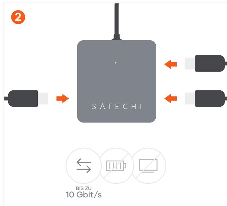
Schließen Sie bis zu 3 USB-C-Geräte für schnelle Datenübertragungen oder Backups an - mit bis zu 10 Gbit/s pro Anschluss.
