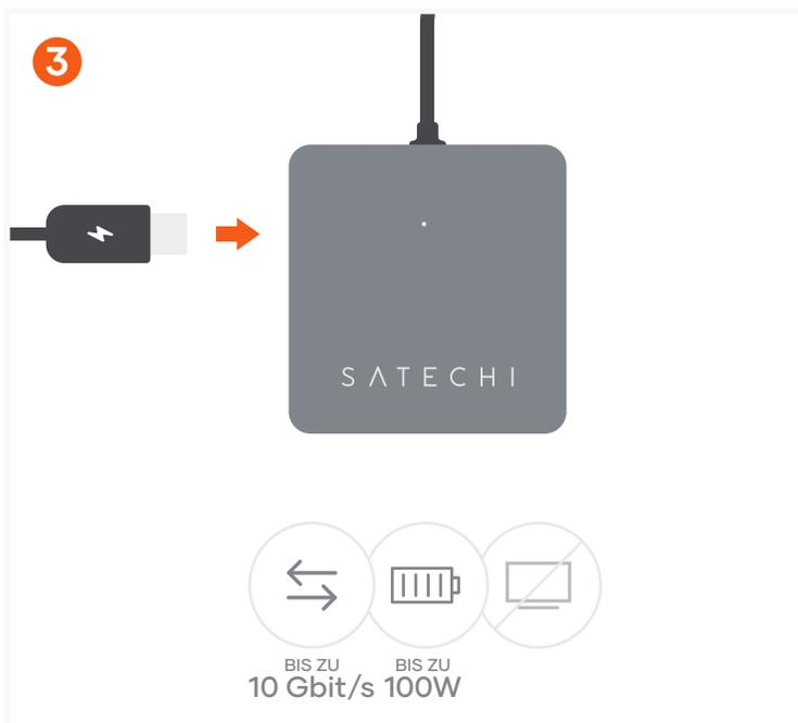
Schließen Sie ein Netzteil am USB-C PD-/Datenanschluss zum Laden an.
