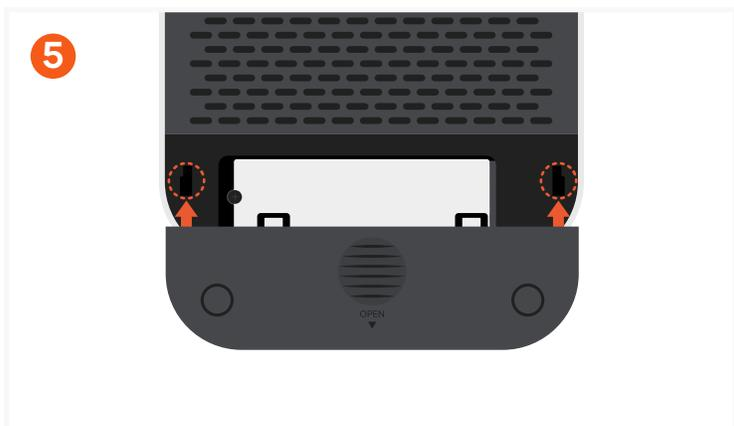
Repositionnez soigneusement le couvercle du boîtier : insérez d'abord les clips latéraux, puis faites glisser le panneau en place.
