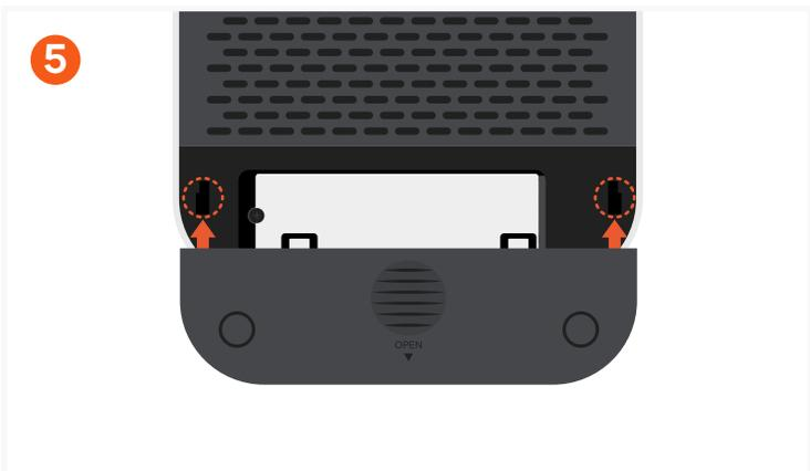
5 Vuelve a colocar con cuidado la cubierta de la carcasa: primero inserta los clips laterales y luego desliza la tapa en su lugar.
