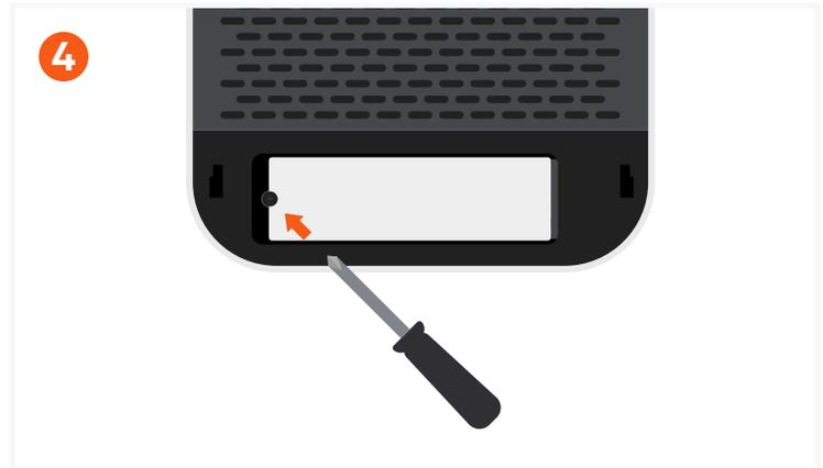
4 Fija la SSD utilizando el destornillador y el tornillo incluidos. Consejo: Para evitar dañar el tornillo, no lo aprietes demasiado.
