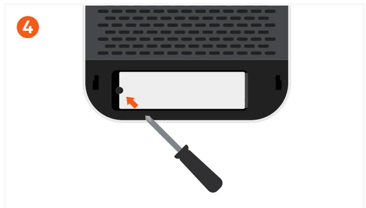
4 Befestigen Sie die SSD mit dem mitgelieferten Schraubenzieher und der Schraube. Tipp: Um das Überdrehen der Schraube zu vermeiden, ziehen Sie sie nicht zu fest an.
