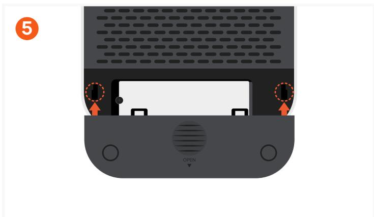
5 Bringen Sie die Abdeckung des Gehäuses vorsichtig wieder an: Setzen Sie zuerst die seitlichen Clips ein und schieben Sie dann die Klappe in Position.
