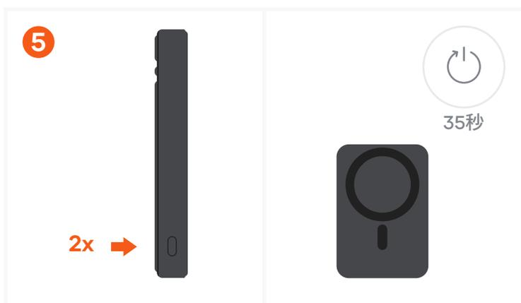
モバイルバッテリーを手動で電源オフにするには、電源ボタンを2回押してください。LEDバッテリーインジケータが消灯します。また、本製品には自動電源オフ機能があり、35秒間操作がない場合や接続機器が検出されない場合に作動します。
