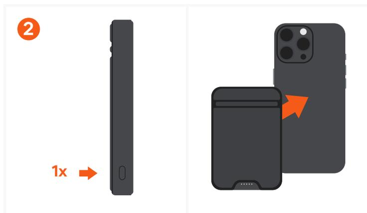
サイドボタンを一度押すか、スマートフォンを置くとモバイルバッテリーが起動します。LEDは14秒間点灯し、その後消灯します。本製品は1台のデバイスに対してワイヤレス充電をサポートします。
