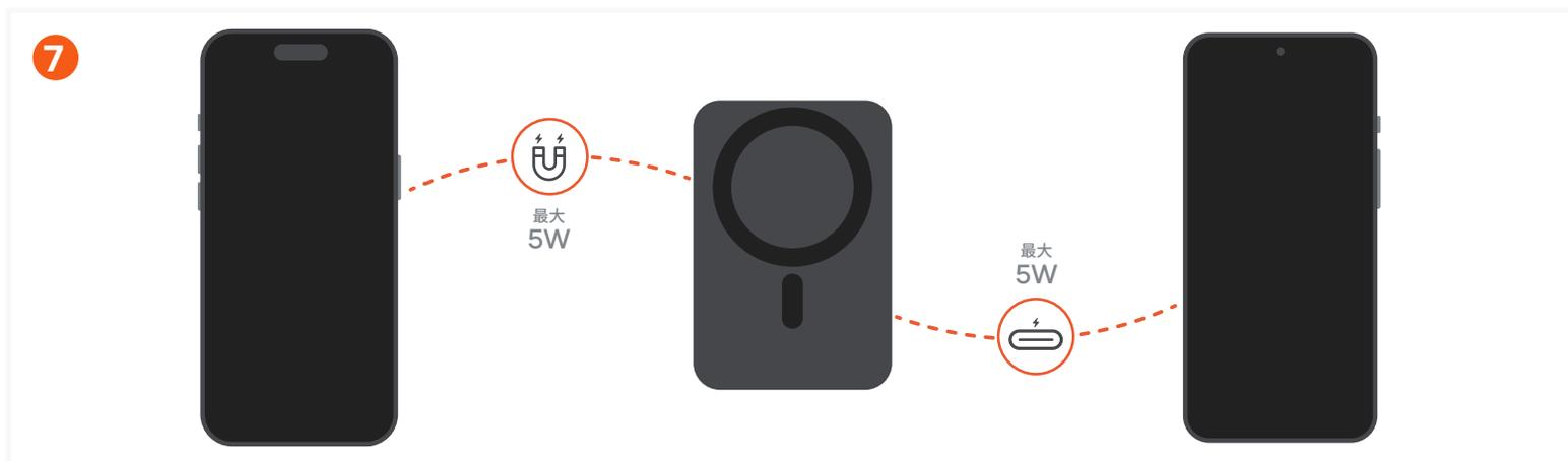
2台のデバイスを同時に充電する場合（ワイヤレス + USB-C）、出力は次の構成になります：Qi2充電器（5W） + USB-C出力（5W）
