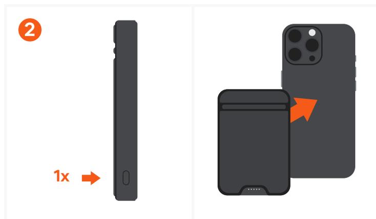
**2** Accendere la batteria premendo una volta il pulsante laterale o collegando il telefono. I LED si accenderanno per 14 secondi e poi si spegneranno. La batteria supporta la ricarica wireless di un solo dispositivo alla volta.
