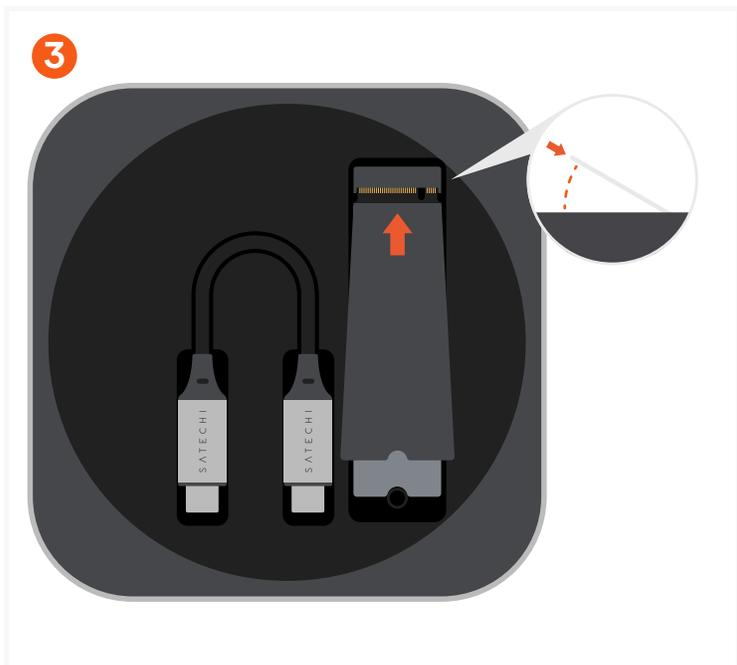
Inserta el SSD (no incluido) en un ángulo leve y presiónalo completamente en la ranura PCIe.
