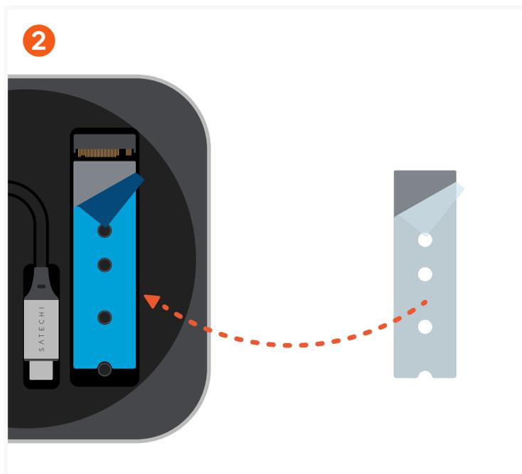
Antes de instalar el SSD, asegúrate de aplicar la cinta térmica incluida.
