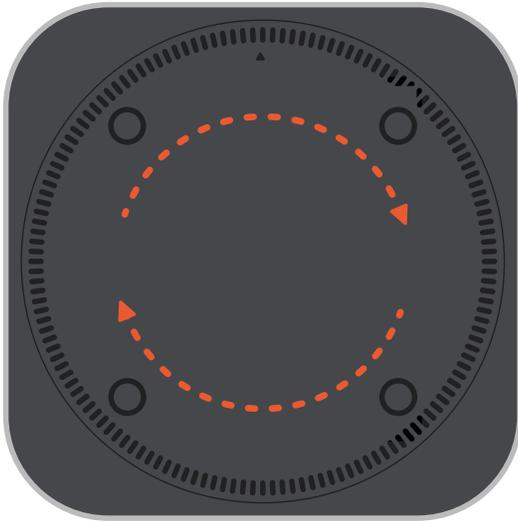
Um die NVMe-SSD zu installieren, drehen Sie die untere Abdeckung des Gehäuses im Uhrzeigersinn, um sie zu entriegeln, und heben Sie die Abdeckung an.
