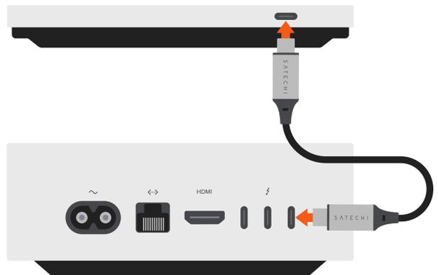
Schließen Sie das USB-C-Kabel an das Gehäuse und anschließend an den USB-C-Anschluss Ihres Computers an.
