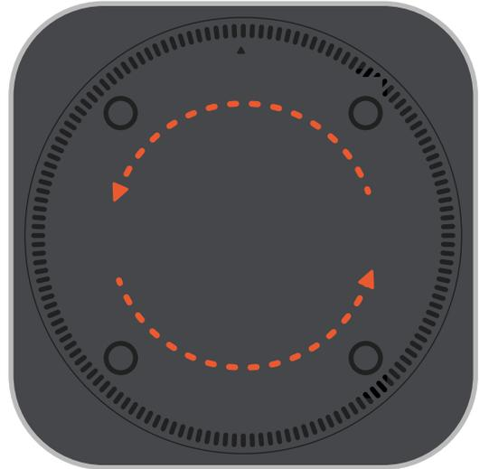
Bringen Sie die Abdeckung wieder an, indem Sie sie gegen den Uhrzeigersinn drehen, bis der Pfeil mit der Kerbe übereinstimmt und sie einrastet.
