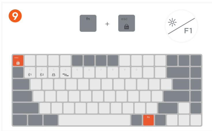
Presiona "FN + Esc" para activar la función de bloqueo de teclas y cambiar entre las teclas Multimedia y las de Funciones (F1-F12). La tecla escape parpadeará cuando la función de bloqueo esté activada.
