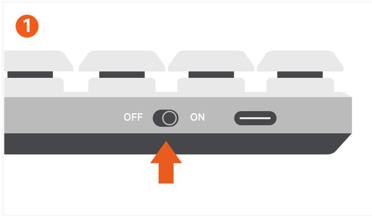
1 Enciende el teclado colocando el interruptor de la parte superior del teclado en la posición "on". La tecla de fuente de última conexión debería iluminarse.
