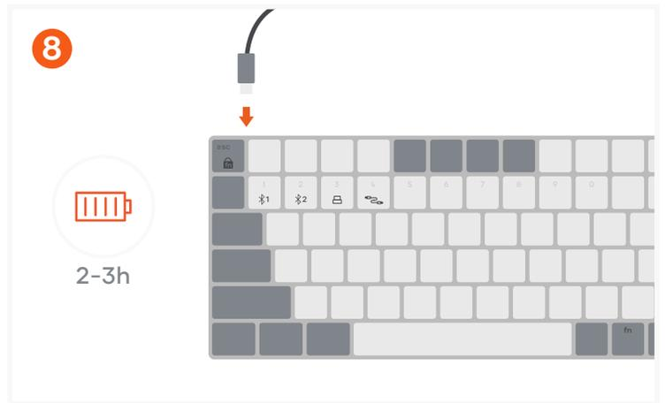
Para recargarlo, conecta el teclado a un puerto USB-C con corriente usando el cable incluido. Carga durante 2-3 horas o hasta que la luz roja se apague.
