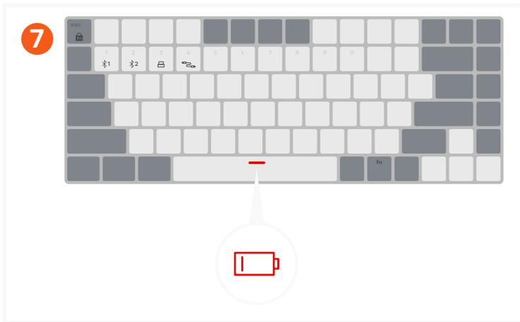
El indicador de corriente de la barra espaciadora parpadeará de color rojo cuando quede poca batería.
