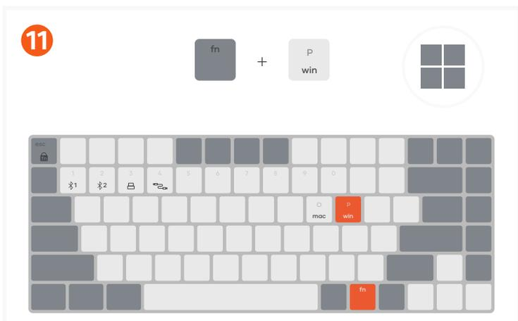
Presiona "FN + P" para cambiar a funciones de Windows.
