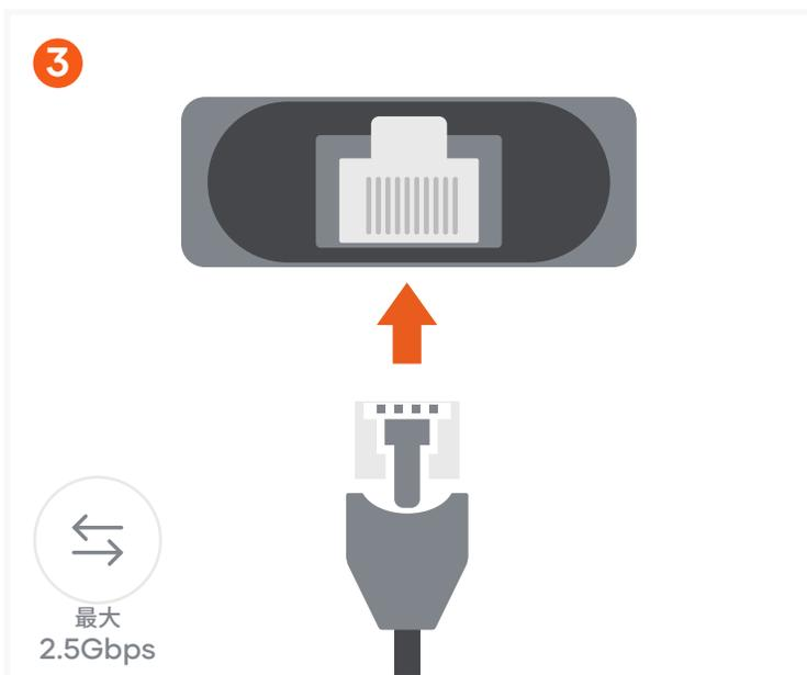
RJ45ケーブルを2.5ギガビットイーサネットポートに接続します。
