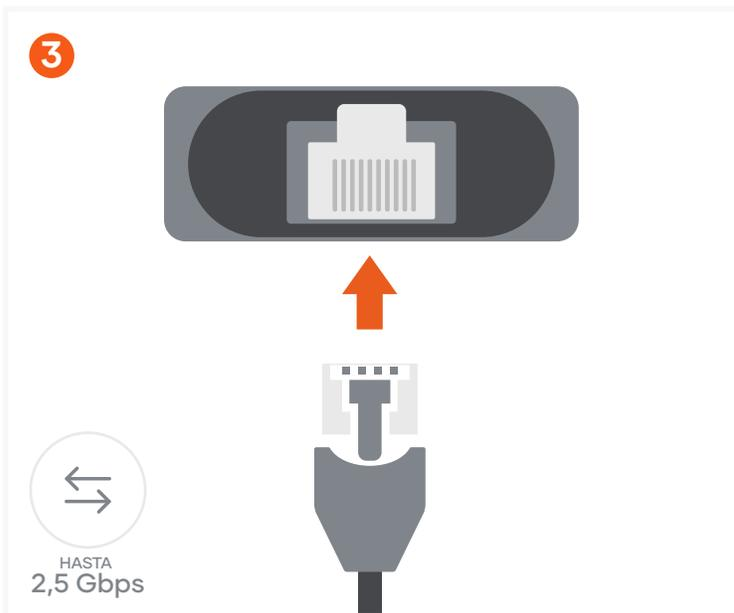
Conecte un cable RJ45 al puerto Ethernet de 2,5 Gigabit. Para alcanzar velocidades de 2,5 Gigabit, tu proveedor de servicios de Internet (ISP) y tu router/modem deben admitir la tecnología Multi-Gig.
