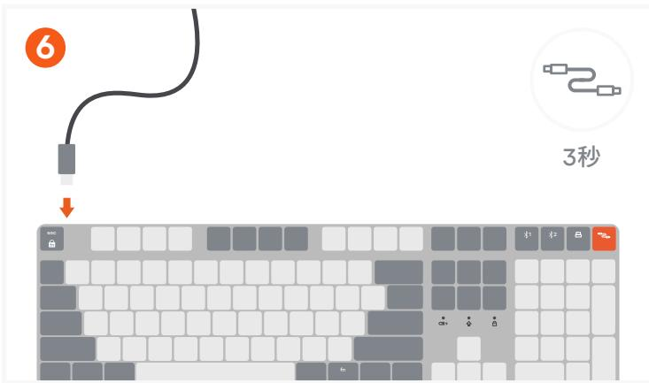
キーボードを有線モードで使用するには、付属のケーブルを接続し、有線モードキーを押し続けて有線モードに切り替えます。有線モードでは、キーボードは充電され、電源がオンのままになります。
