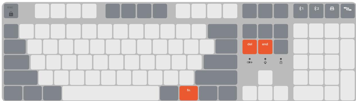
すべてのデバイス接続をリセットするには、「FN + Del + End」を押します。
