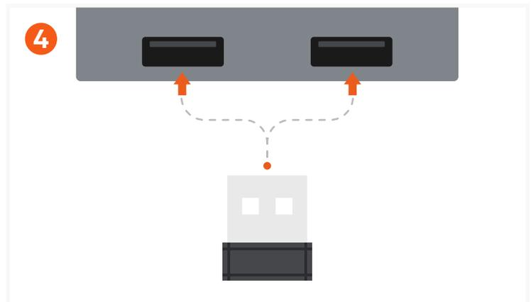
Conecta el receptor inalámbrico USB-A de 2,4 GHz incluido a un puerto USB-A disponible en tu ordenador, adaptador, concentrador o estación de acoplamiento.
