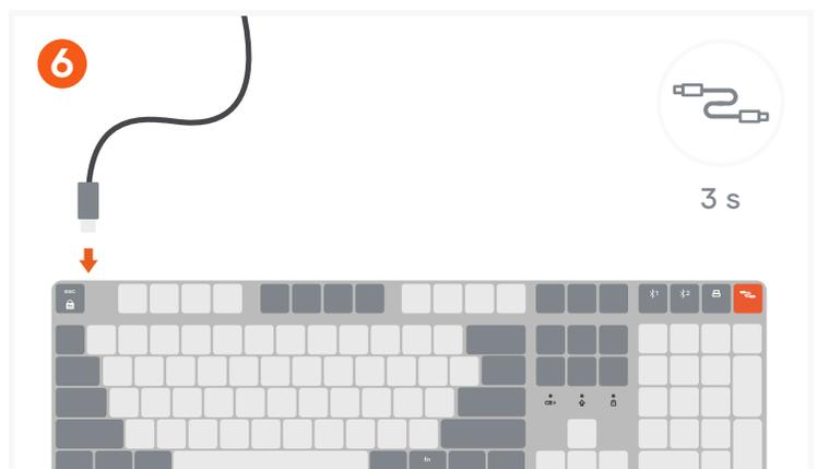
Para activar el modo cableado, conecta el teclado utilizando el cable incluido y mantén presionada la tecla correspondiente para cambiar a la conexión por cable. En modo cable, el teclado también se cargará y permanecerá encendido.
