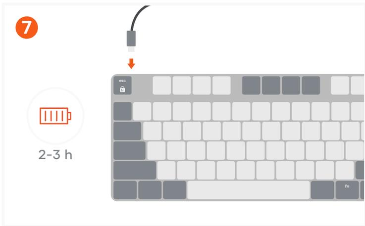
Para recargar, conecta el cable de alimentación USB-C incluido al puerto USB-C del teclado; el LED de carga se iluminará.
