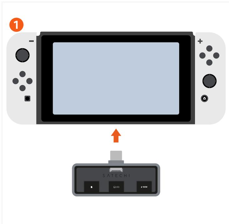
Collega l'adattatore a un dispositivo host compatibile. L'indicatore LED si accenderà una volta connesso.
