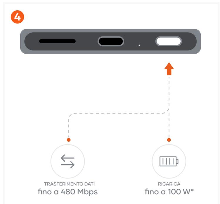
Collega un cavo di ricarica USB-C a una delle porte USB-C PD. Supporta USB 2.0, plug & play; PD3.1 SPR, con un ingresso massimo fino a 100 W a seconda del dispositivo host.
