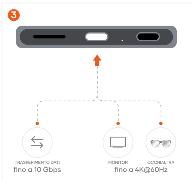
Collega un cavo Thunderbolt 4, USB4 o USB-C a HDMI/DP alla porta USB-C. Supporta USB 3.0 a 10 Gbps, DP1.4 a 2 corsie con 8,1 Gbps per corsia, DP1.2 a 4 corsie per iPhone 15 e 16, e modalità 4K@60Hz a seconda del dispositivo host e dello schermo.
