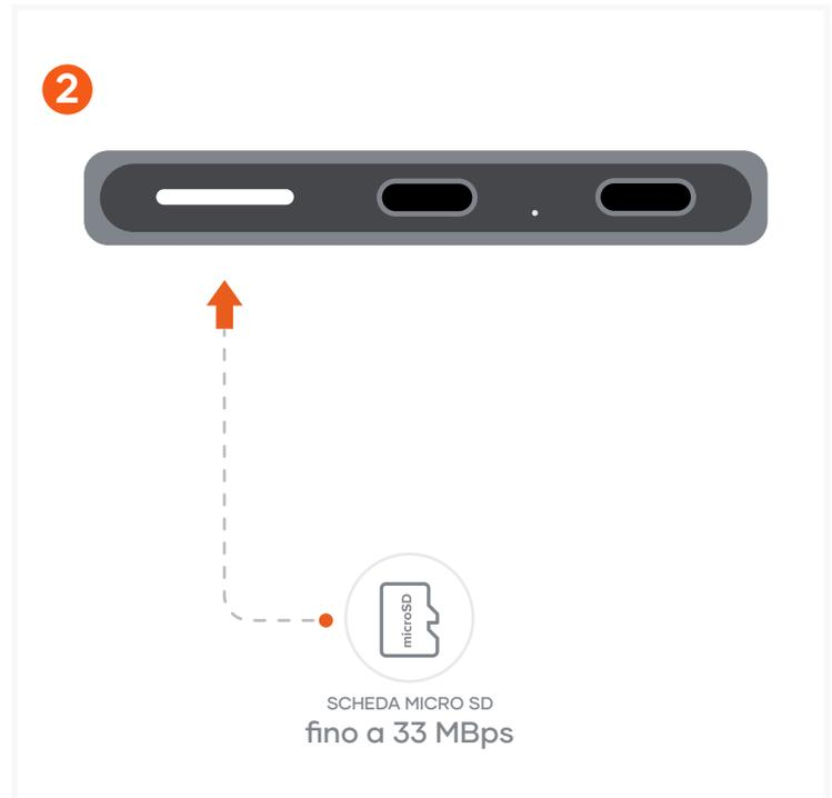
Inserisci una scheda microSD UHS-I nello slot del lettore di schede. Supporta schede microSD UHS-I SDXC.
