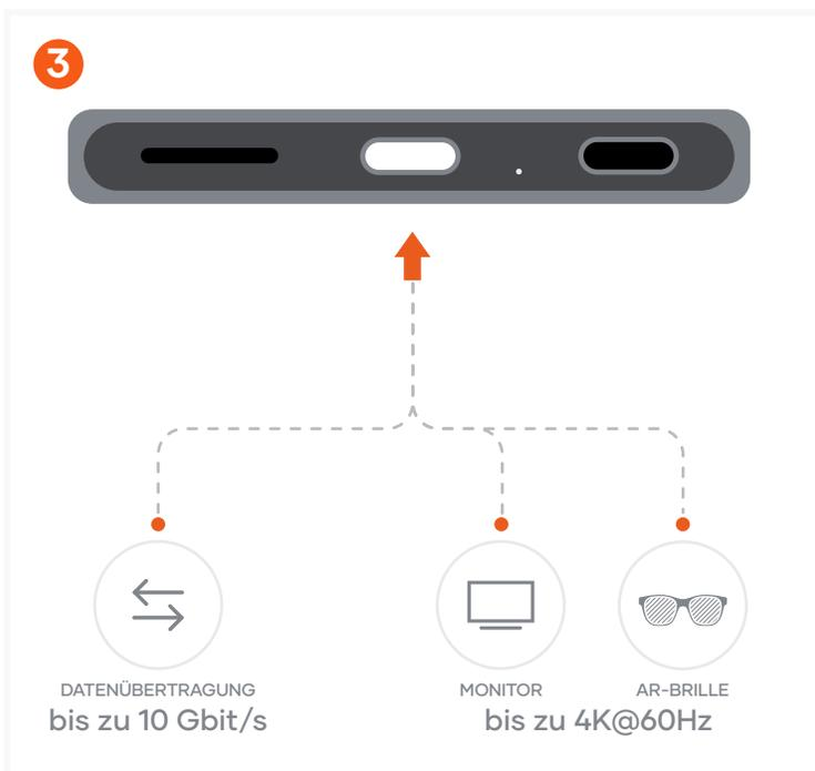
Schließen Sie ein Thunderbolt 4-, USB4- oder USB-C-zu -HDMI/DP-Kabel an den USB-C-Anschluss an. Unterstützt USB 3.0 bei 10 Gbit/s, 2-lane DP1.4 mit 8,1 Gbit/s pro Lane, 4-lane DP1.2 für iPhone 15 und 16, und 4K@60Hz-Modus, abhängig vom Host-Gerät und Bildschirm.
