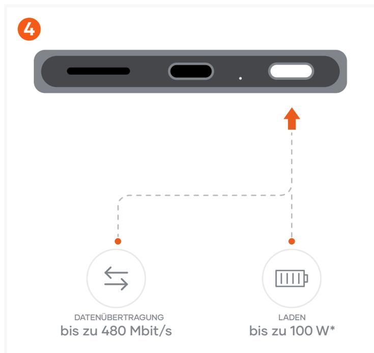
Schließen Sie ein USB-C-Ladekabel an einen der USB-C-PD-Anschlüsse an. Unterstützt USB 2.0, Plug & Play; PD3.1 SPR, mit einer maximalen Eingangsleistung von bis zu 100 W, abhängig vom Host-Gerät.
